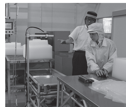
作業手順などをプロジェクションマッピングで映し出す独自開発の作業台
